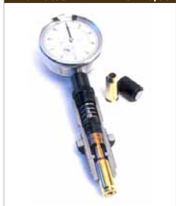
Comparatore micrometrico per l'altezza del Headspace, (colletto e spalla del bossolo). Inserendo il bushing corrispondente al calibro, comparazione "del Seating" (altezza palla).
